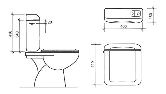
La soupape fournie par REGIPLAST est réglée en usine à 9 L. Pour obtenir un volume de 6 L, effectuer le réglage ci-dessous:
